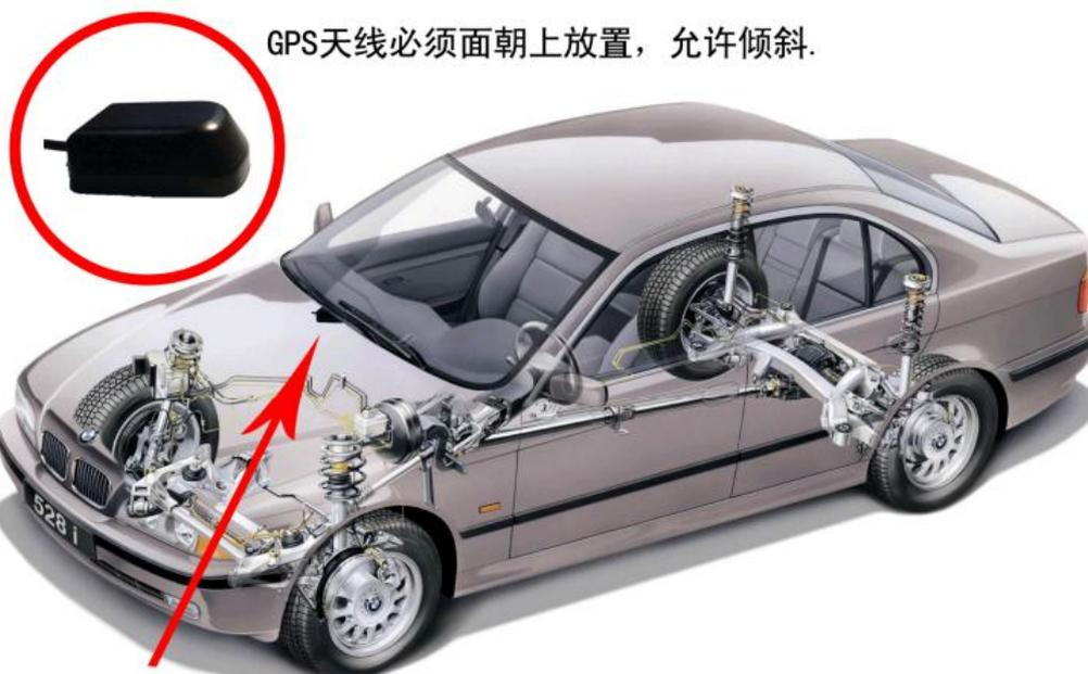
GPS天线位置，建议放置在挡风玻璃正下方塑料壳底下。
